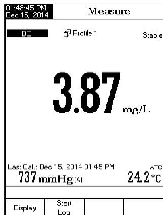
*Notas: Para una medición adecuada de OD, un movimiento de 0.3 m/s es requerido. Esto asegura que el oxígeno consumido en la superficie de la membrana es remplazado constantemente. El movimiento de la muestra proveerá una adecuada circulación. Si la lectura esta fuera de rango, el icono "-----" se mostrará en pantalla.*
