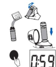
• Mantenga presionado el botón hasta que se muestre el temporizador en la pantalla LCD (la pantalla mostrará la cuenta regresiva antes de la medición) o, alternativamente, espere 1 minuto y presione el botón.
