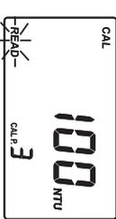
**Nota:** En este momento es posible salir de calibración pulsando CAL/RCL. El instrumento memorizará los datos de calibración a dos puntos ( $<0,10$  y 15,0 NTU) y volverá a modo medición.
