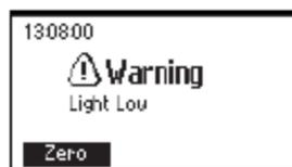
**Luz Baja:** El instrumento no puede ajustar el nivel de luz. Por favor compruebe que la muestra no contiene algún residuo.
