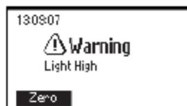
**Luz Alta:** Existe demasiada luz para llevar a cabo una medición. Por favor compruebe la preparación de la cubeta cero.
