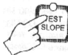
El valor obtenido podrá variar si ajustamos con el potenciómetro SLOPE.
