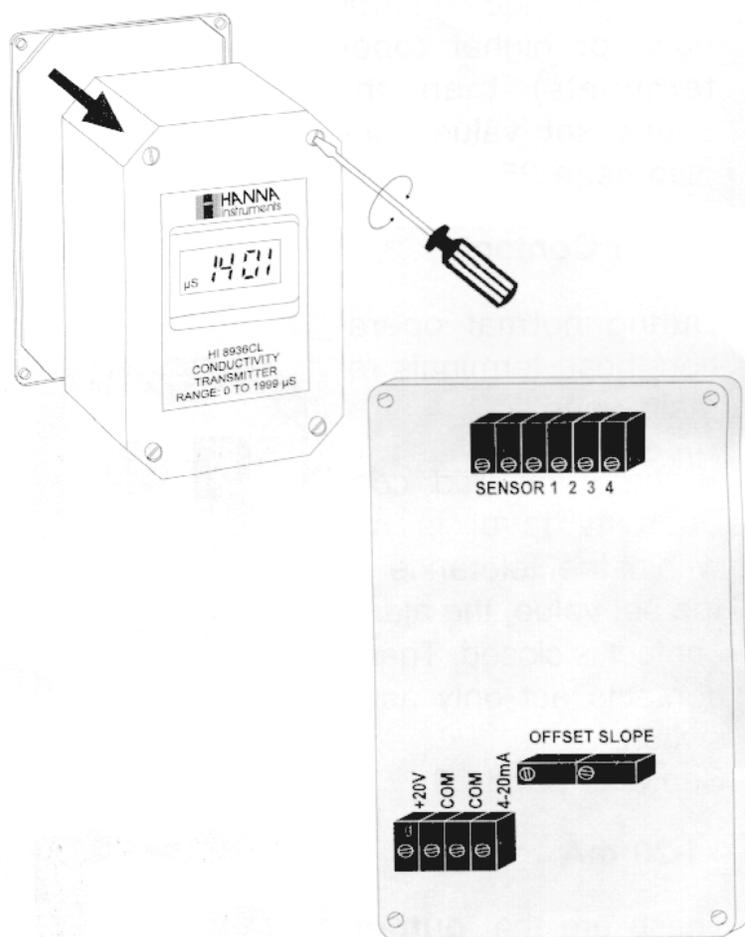
Para acceder a las regletas de conexión, aflojar los 4 tornillos frontales. Retirar la base del transmisor. Una vez finalizada la conexión vuelve a colocar la base junto al transmisor y fíjelo a una pared.
