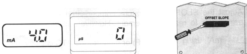
El HI - 8931 debería medir también 0  $\mu$ S. Si el valor no coincide, podrá solventarlo con el potenciómetro OFFSET del controlador.
