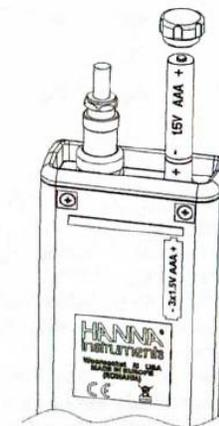
El instrumento es proporcionado con la característica BEPS (Sistema de Prevención Error de Batería), la cual desactiva el medidor automáticamente si el nivel de la batería está demasiado bajo para garantizar lecturas confiables. En el inicio la pantalla mostrará el mensaje "0 bAtt" por unos pocos segundos, luego el instrumento se apagará automáticamente.
