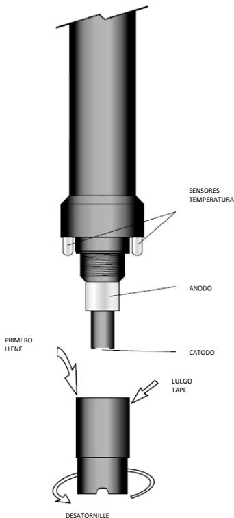
4. Con el sensor mirando hacia abajo atornille la tapa hasta el final de los hilos. Algo de electrolito se desbordará.
