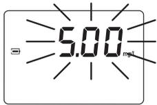
Over Range: Un valor parpadeante de la máxima concentración indica una condición por encima de rango. La concentración de la muestra está por encima del rango programado: diluya la muestra y vuelva a realizar el test.
