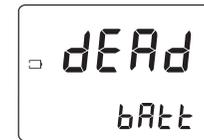
Dead battery: Esto indica que la pila está agotada y debe ser sustituida. Tras mostrar esta indicación, el medidor se desconectará. Cambie la pila y reinicie el medidor.
