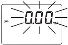
Under range: Un mensaje "0.00" parpadeante indica que la muestra absorbe menos luz que la referencia cero. Compruebe el procedimiento y asegúrese de que usa la misma cubeta para referencia (cero) y medición.
