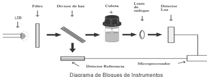
El sistema de referencia interno (detector de referencia) del fotómetro [HI97762](#) compensa cualquier desviación debido a fluctuaciones de energía o cambios de temperatura ambiente, proporcionando una fuente de luz estable para su medición en blanco (cero) y medición de muestra.
