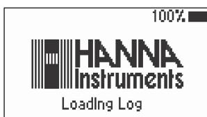
Al inicio, la pantalla mostrará el logotipo de Hanna Instruments durante unos segundos, seguido de la indicación del porcentaje de la vida útil restante de la batería y el mensaje “**Cargando Registro ...**” (“**Loading Log...**”), luego ingresa al modo de medición.
