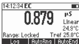
Se muestra el mensaje “Rango: Bloqueado” (“Range: Locked”). Para restaurar la opción de rango automático, presione nuevamente la tecla funcional “AutoRng”.
