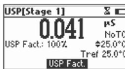
Si la fuente de temperatura es de entrada manual, presione **USP Fact.** para seleccionar el factor USP que se va a cambiar (se muestra ▲ antes del valor del 100%). Para aumentar la precisión del análisis, disminuya el valor del factor USP.
