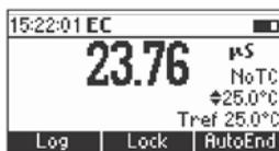
Si la temperatura está fuera del rango de  $-20^{\circ}\text{C}$  a  $120^{\circ}\text{C}$ , el instrumento no compensará la temperatura.
