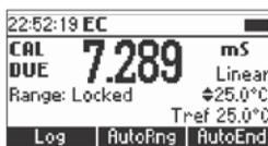
Por ejemplo, si se ha seleccionado un intervalo de 4 días, el instrumento emitirá la alarma exactamente 4 días después de la última calibración.
