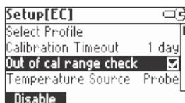
Presione la tecla funcional correspondiente para habilitar / deshabilitar esta función. Si está habilitada, se muestra un mensaje de advertencia cuando la lectura de CE está demasiado lejos de los puntos de calibración de CE.
