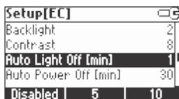
Presione 5, 10 o Desactivado para cambiar la configuración.
