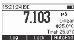
La conductividad del agua natural muestra un fuerte comportamiento de temperatura no lineal.
