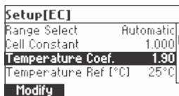
Presione **Modificar (Modify)** para configurar el coeficiente de temperatura.
