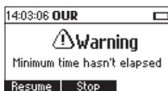
Presione Resume para continuar el test o Stop para finalizar el test.
