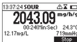
Si desea interrumpir la prueba de SOUR antes de que transcurra el periodo de tiempo máximo establecido en la configuración, pulse Stop.
