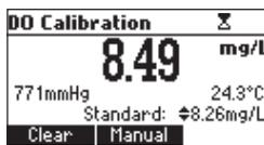
Aparecerá en pantalla el mensaje "Calibration cleared" durante unas segundos y el medidor volverá a la pantalla principal. Si al acceder a la pantalla de calibración de O.D. la función de presión manual se activa, la tecla Clear se activará durante 5 segundos; después será sustituida por la tecla Pressure/Standard.
