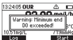
*Pulse cualquier tecla para cerrar el mensaje o pulse HELP para ver información detallada de la advertencia. Si el O.D. obtenido al final de la prueba es superior al obtenido al principio, aparecerá un mensaje de error.*
