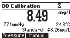
Si anteriormente realizó una calibración puede borrarla pulsando la tecla Clear (Borrar) de la pantalla de calibración del O.D.
