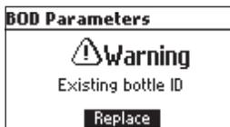
Si ya existe un frasco con el mismo ID, el instrumento le preguntará si desea sustituirlo. Pulse Replace para sustituir el registro existente o ESC para regresar a la pantalla anterior sin hacer la sustitución. Cada vez que almacene un nuevo registro, el medidor mostrará un mensaje indicando el espacio libre restante (en %) para almacenar datos iniciales de DBO.
