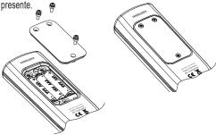
Reemplace las tres pilas alcalinas AAA de 1.5V ubicadas en el compartimiento de las pilas, respetando la polaridad indicada.
