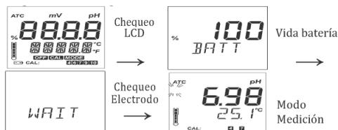
*Nota: El medidor detecta la presencia y el tipo de sonda en su entrada.*
